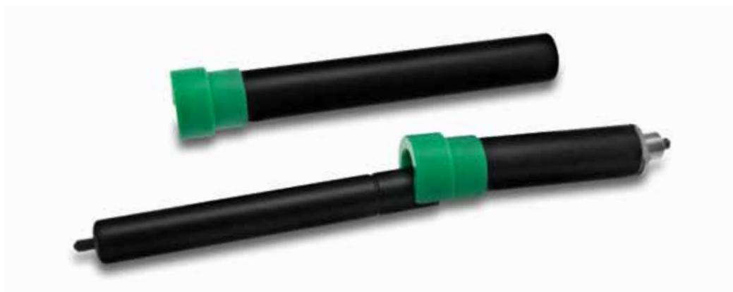
La molla a gas con la funzionalità Push Top possiede un sistema di bloccaggio meccanico della corsa nella posizione di tutto aperto. Il blocco si configura come un tubo che copre lo stelo della molla a gas e che scorre all'esterno del cilindro. Una volta raggiunta la posizione di tutto aperto tale tubo, grazie ad un sistema a molla, si disallinea rispetto al corpo bloccando la corsa della molla. Premendo sul pulsante colorato il tubo di sicurezza si riallinea sbloccando la corsa.
