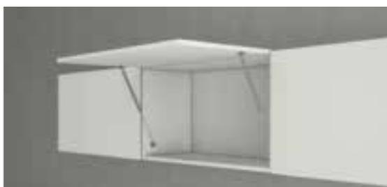
Im Fall von Anwendungen mit waagerechter Feder muss der Befestigungspunkt so gewählt werden, dass die Feder in der vollständig geschlossenen Position eine Neigung nach unten von mindestens  $10^\circ$  beibehält, damit sie auch den Fall der Abdeckung begleiten kann, ohne dass diese dabei unsanft aufschlägt.
